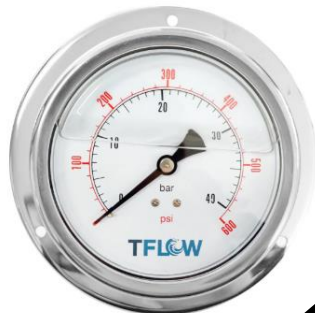
Manómetro para Panel con Glicerina- Ajuste con Brida-0 - 600 PSI - 4.5" Diámetro- 1/4" NPT
