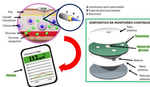
Ilustración 2: Monitoreo continuo de la glucosa mediante un sensor CGM. Imagen propia.
