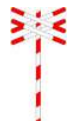
J13 Waarschuwing voor overweg met twee of meer sporen zonder slagbomen (dubbele Andreaskruis)
