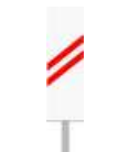
BB23-2L Waarschuwbak links van rijbaan op 160 m voor beweegbare brug of spoorwegovergang
