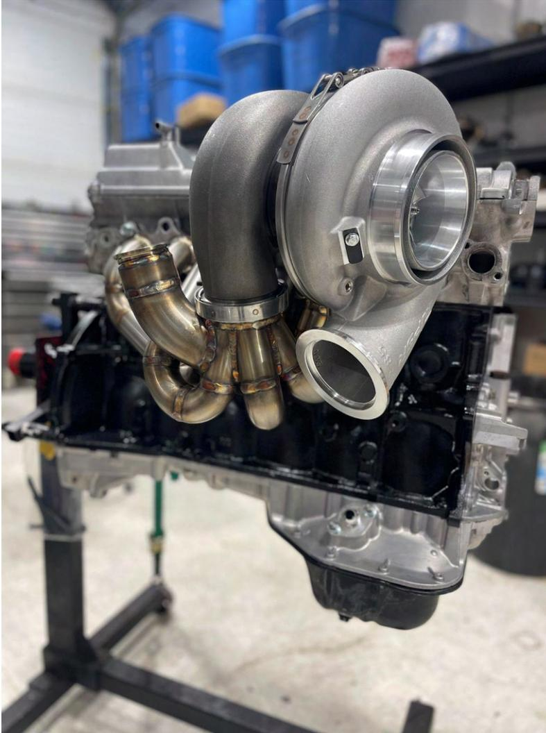
b. Montez le turbocompresseur sur le raccord du collecteur.
