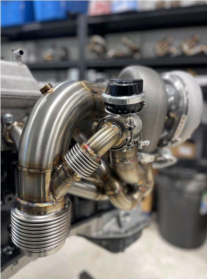
d. (seulement la soupape de dérivation recirculée) Lorsque le downpipe est entièrement monté, serrez l'écrou V-Band sur le collier et la soupape de dérivation également pour un ajustement final.
