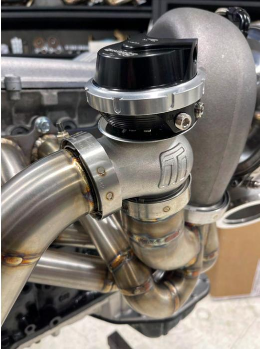
b. Fixez la soupape de dérivation à l'aide du matériel fourni (appliquez de l'anti-grippant sur l'écrou et les filets).
