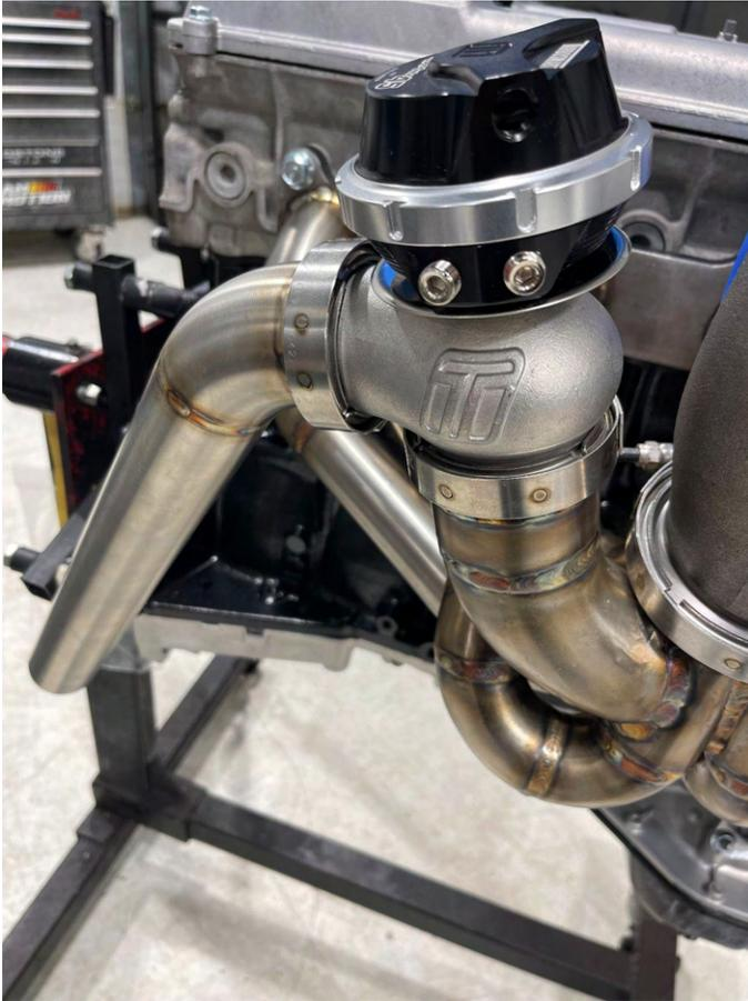
b. Fixez le tube de décharge avec le matériel fourni (appliquez de l'anti-grippant sur l'écrou et les filets).
