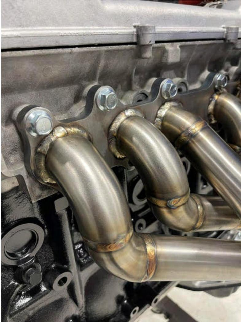
b. Placez le collecteur turbo KMP Speedshop en position et réutilisez le joint d'échappement et les boulons d'origine s'ils sont en bon état.
