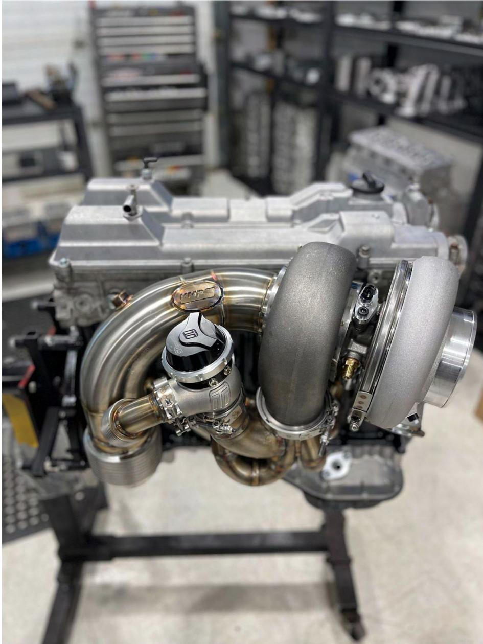
b. Fixez le downpipe à l'aide du matériel V-Band fourni (appliquez de l'anti-grippant sur l'écrou et les filets).
