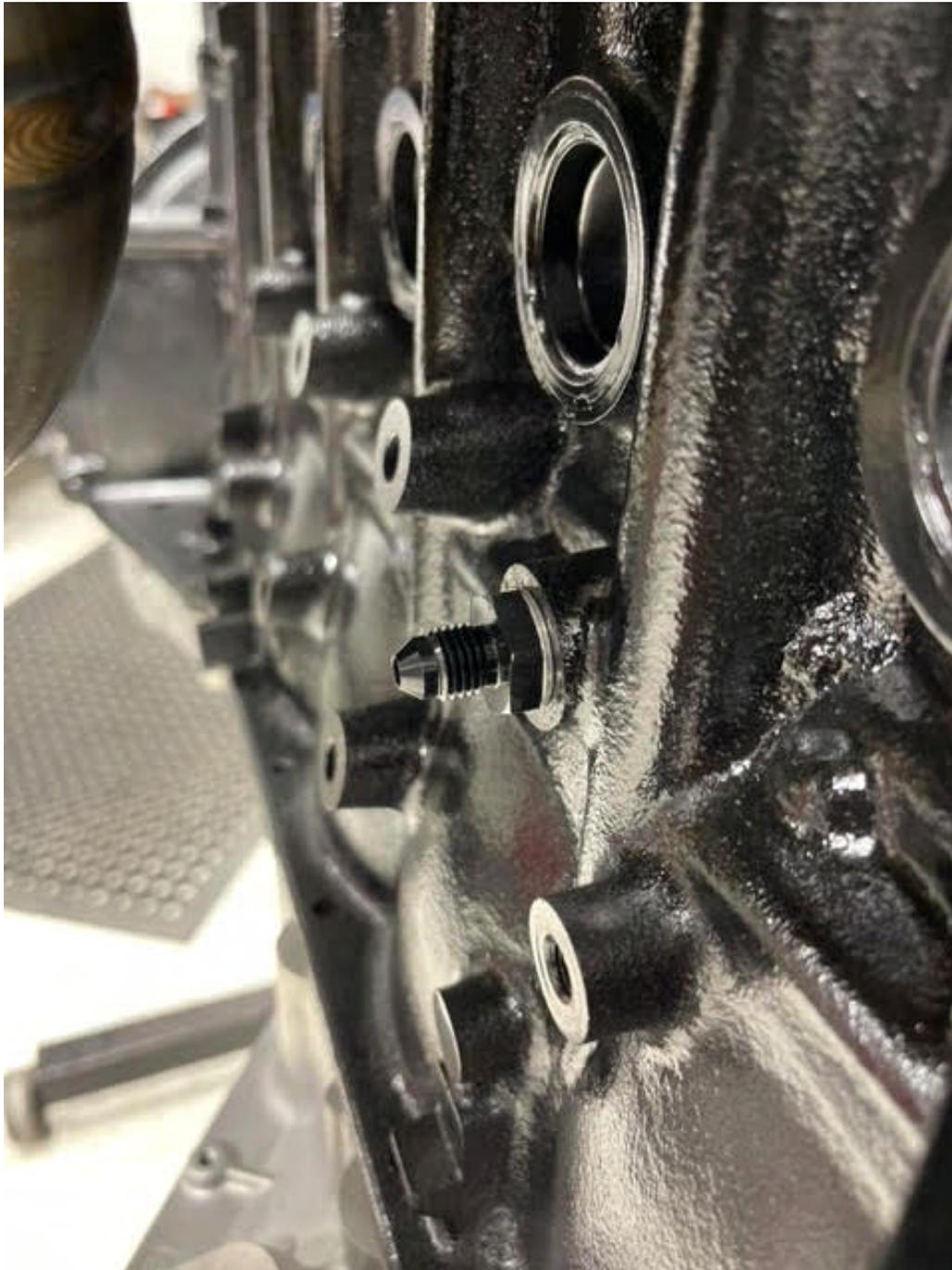
b. Acheminez la ligne d'alimentation en huile du bloc moteur à l'entrée d'huile du turbocompresseur.
