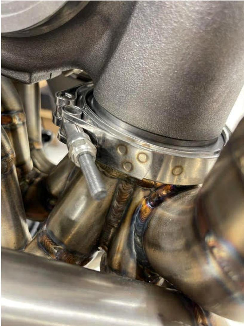
d. Serrez les boulons selon les spécifications du fabricant (6 pi/lb).
