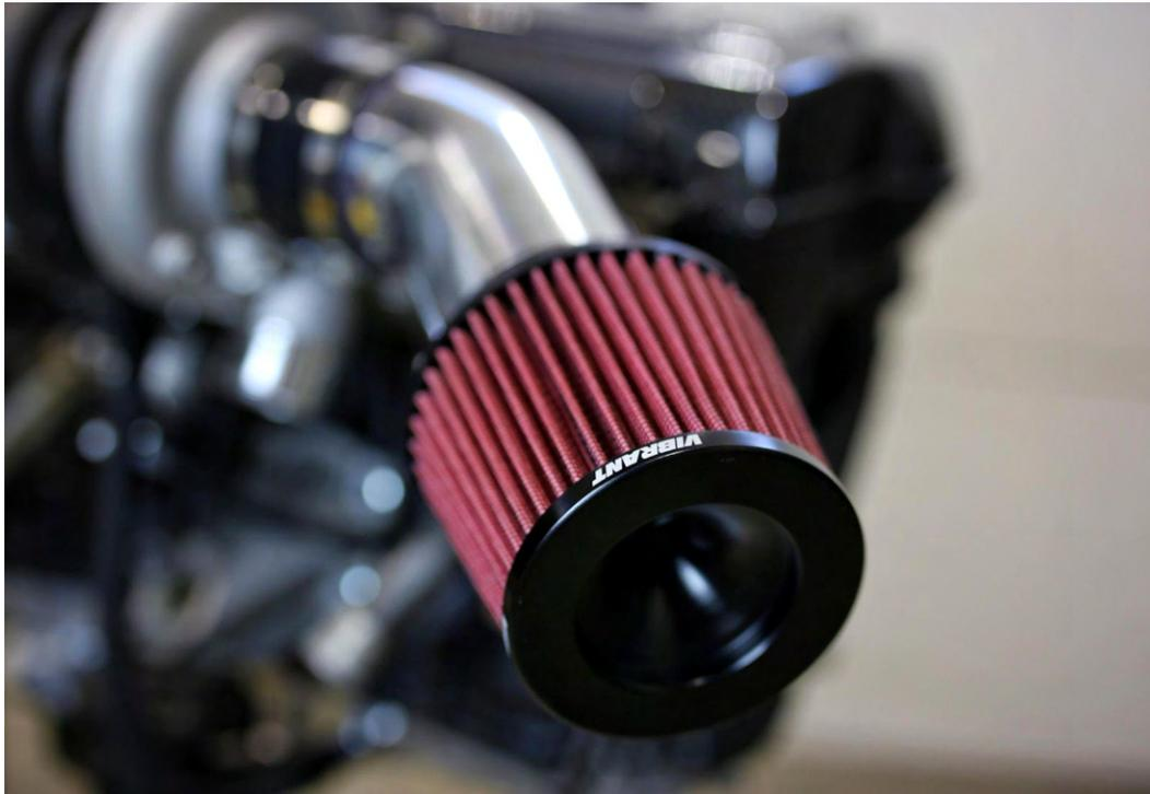
b. Fixez le tuyau d'entrée et le filtre à air vibrant avec les colliers fournis.
