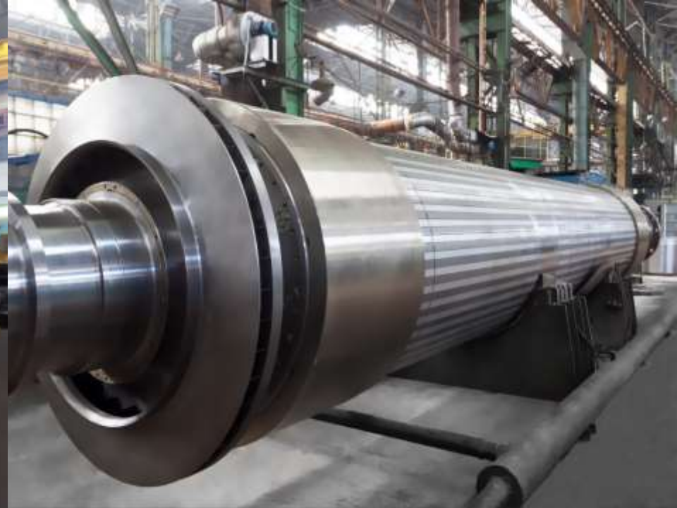
Ротор турбогенератора ТГВ-325-2АУЗ на участке сборки
