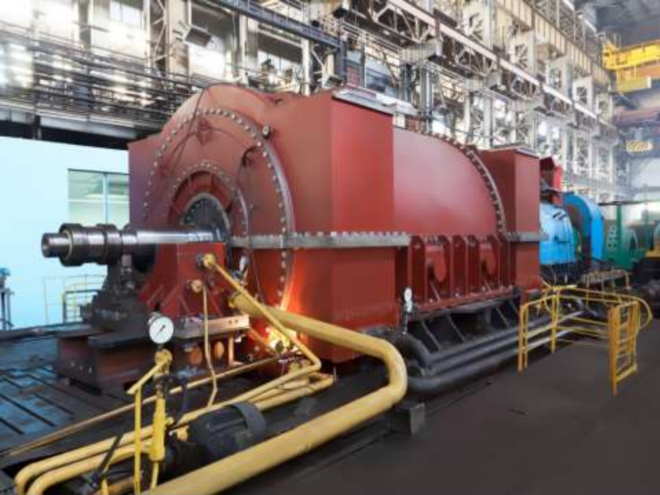
Турбогенератор ТГВ-215-2ПТЗ для ТЭС «Бандель» (Индия) на испытательном стенде
