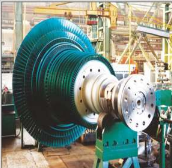
K-325-23.5 steam turbine rotor for «Izno» TPP (Kazakhstan)
