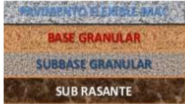
**Material Selecto y Capa base:** Dichos materiales no deben superar un tamaño de 2 a 3'' ya triturado, su origen se da la en las canteras de extracción y triturado de material donde las partículas de los agregados serán duras, resistentes y durables, sin exceso de partículas planas, blandas o des-integrables, no deben tener materia orgánica, arcilla o exceso de humedad.
