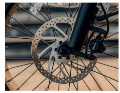
**TEKTRO HYDRAULIC DISC BRAKES**
