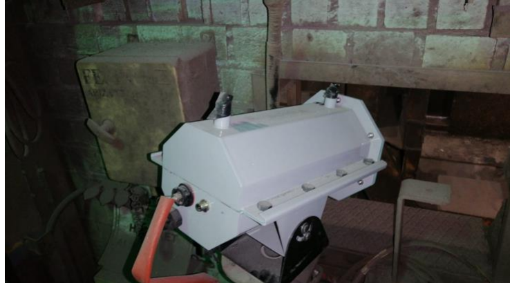
Fotoğraf 21: Su ve hava soğutmalı kamera muhafazası ve sahadaki uygulaması
