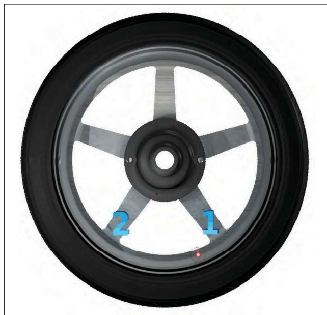
Figure 25 : Emplacements du rayon 1 et 2 des deux côtés de l'emplacement original du poids externe
