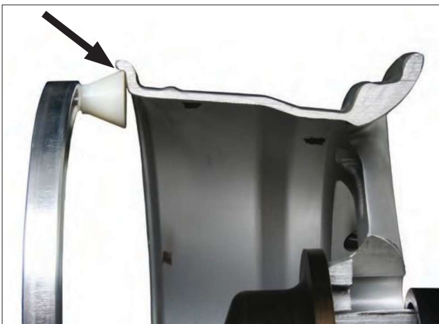
Figure 8B – Vue de l'emplacement des poids d'équilibrage accrochés sur une jante en coupe
