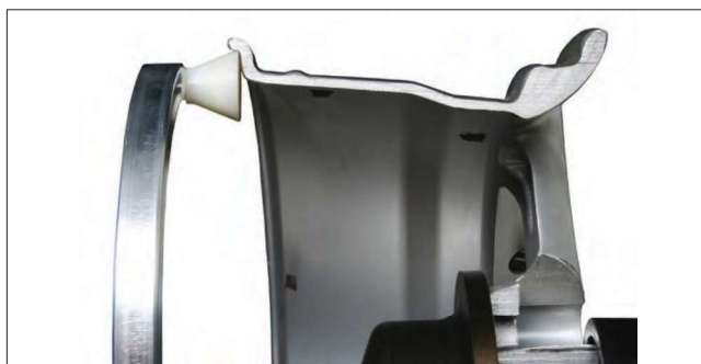
Figure 2 – Emplacement des poids d'équilibrage pincés
