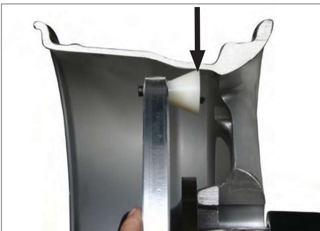
Figure 9A – Vue de l'emplacement des poids d'équilibrage cachés sur une jante en coupe pour plus de clarté
