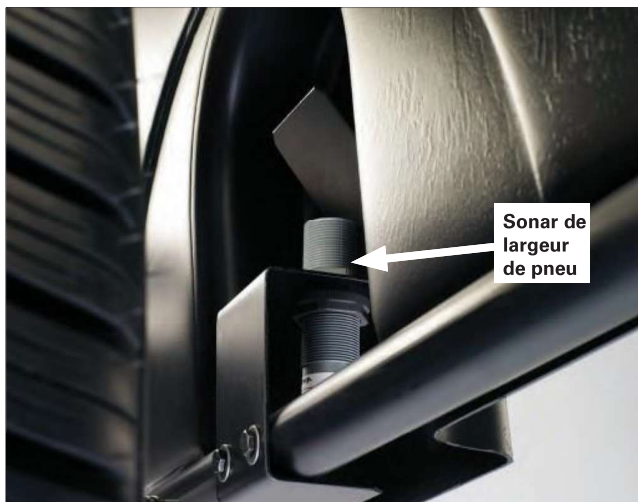
Figure 12 – Sonar de largeur de pneu situé dans le capot
