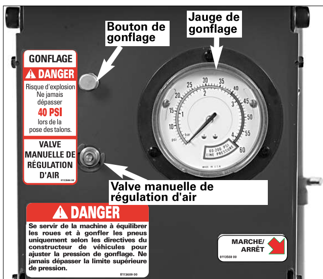
Figure 4 - Panneau de la jauge de gonflage et vignette indiquant l'emplacement de l'interrupteur Marche/Arrêt à l'arrière du boîtier de l'équilibreuse.
