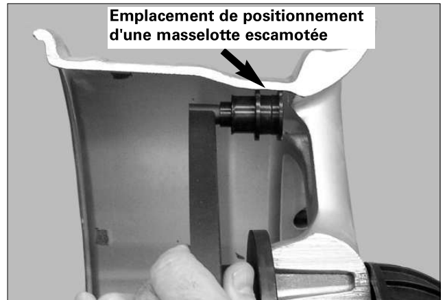
Figure 10 - Emplacement d'une masselotte adaptable - Jante illustrée en coupe transversale pour une plus grande clarté des détails.
