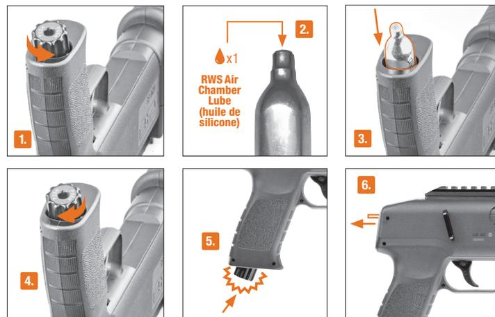
Si l' arme ne fait pas un bruit sec après avoir pressé la détente, le CO<sub>2</sub> n' a pas été déchargé. Si la goupille n' est pas visible (voir **section 4, étape 5**), vérifiez si la vis de perforation est serrée et assurez-vous de la frapper pour perforer la bouteille.
