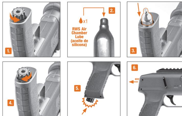
Si el marcador no hace un ruido de estallido después de tirar del gatillo, el CO<sub>2</sub> no está siendo descargado. Si el indicador del pin no está extendido (Vea **Sección 4, Paso 5**), chequee que el tornillo perforador está socado y asegúrese de darle un golpe para que perforo la cápsula.
