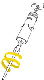
1. Para instalar la punta extensora atorníllala en la punta del inyector.
