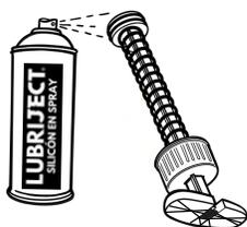
4. Aplica de forma directa un poco de silicón en spray LUBRIJECT sobre los empaques (O-Rings) y ensambla.
