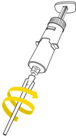
1. Enrosca la punta extensora en la punta del inyector.
