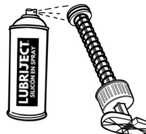
3. Aplica de forma directa un poco de silicón en spray **LUBRIJECT** sobre los empaques (O-Rings).
