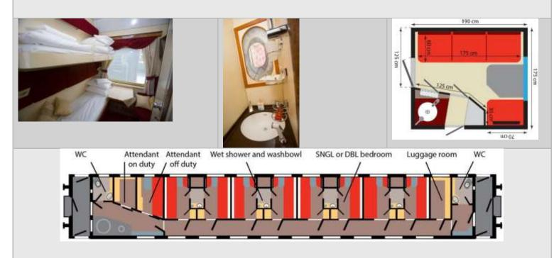
El vagón es de 8 compartimentos, 2 camas en cada uno, arriba y abajo. Una mesa y un sillón. Un equipo de LCD TV. Un armario para guardar ropa. La ducha a ras de suelo y el lavabo compartidos entre 2 compartimentos con acceso propio. En el compartimento número 9 se guarda el equipaje. 2 baños ecológicos al principio y al final del vagón. Aire acondicionado general para todo el vagón con la posibilidad de regularlo  $\pm$  3 CO desde cada compartimento.
