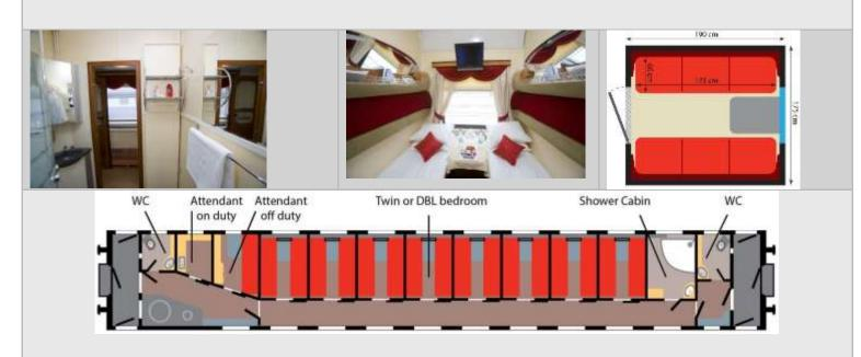
El vagón es de 8 compartimentos, 2 camas abajo. Una mesa. Un equipo de LCD TV. Un espacio para guardar ropa. En el compartimento número 9 está la ducha (cabina) con el lavabo. 2 baños ecológicos al principio y al final del vagón. Aire acondicionado general para todo el vagón con la posibilidad de regularlo  $\pm$  3 CO desde cada compartimento.
