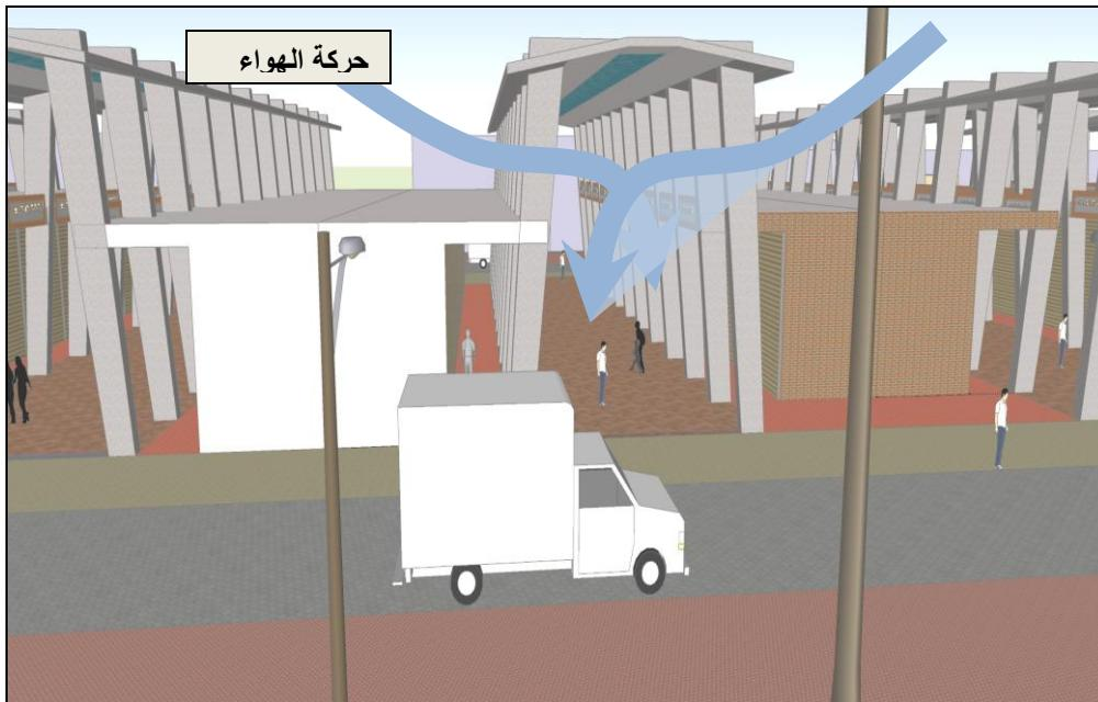
نجد التحليل الفني لتصميم المبني لسوق الصفافير ذو طابع قديم وهو بشكل التهوية العلوية للمبني لدخول الهواء تحت سقف المبني الخرساني العلوي الذي يذكرنا بطريقة الملاقف الهوائية وهذا بحث ذاته يعطي المبني تهوية طبيعية وحركة الرياح إلى الداخل والخارج مما ينشعش السوق في تجدد الهواء داخل السوق .
