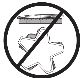
Tapa del quemador incorrecta
