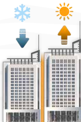
Expansión y contracción de las estructuras
