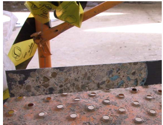
La perfecta adherencia se caracteriza por una rotura mediante arrancamiento del soporte.
