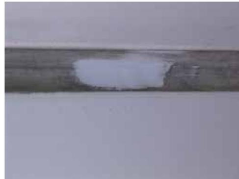
Fotografía de un sello de junta de silicón en la que el sellador fue limpiado para mostrar la acumulación de absorción de suciedad.
