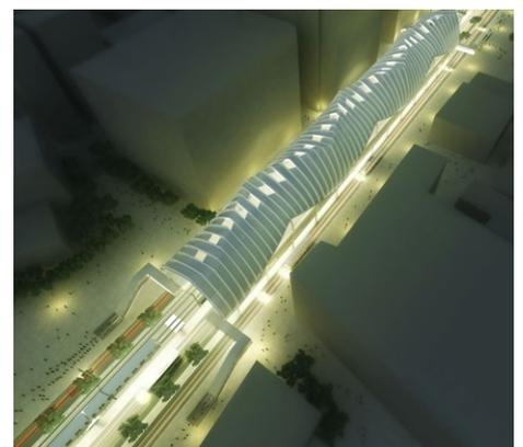
**Estación de Metro de South Kensington.** La reutilización de una de las vías en desuso y la instalación de ascensores en los pozos de ventilación permitirán un incremento en la capacidad de la estación y su uso por PRM.
