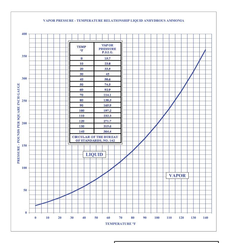
VAPOR PRESSURE-TEMPERATURE CURVE
