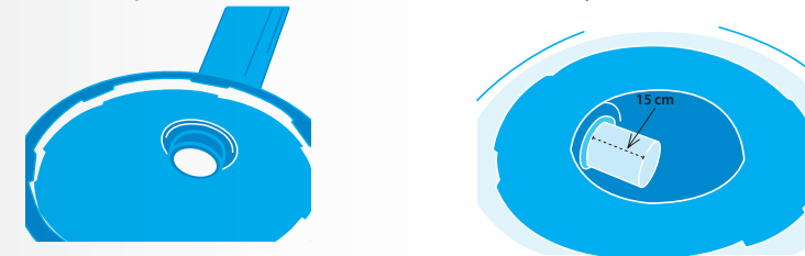
Fig.23. Instalación de Filtro de hojas interno.
