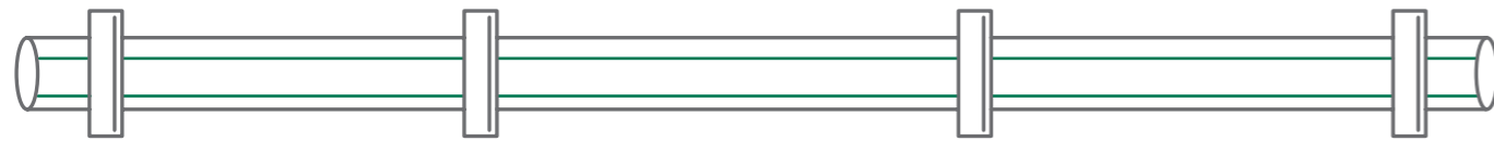
Soportería con Tuboplus Alta Presión (PPR-CT)
