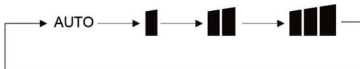
Lorsque le mode de fonctionnement change, la vitesse de ventilation reste à la valeur initiale définie. En mode AUTO (AUTO), le système sélectionne automatiquement la vitesse de ventilation adéquate en fonction du réglage d'usine. En mode DRY (SÉCHAGE), la vitesse de ventilation est définie par défaut au niveau faible et ne peut être ajustée.
