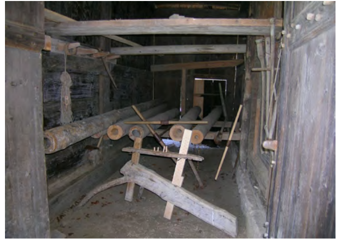
43 Freilichtmuseum der Schweiz, Taunerhaus aus Detligen: Im Tenn des Taunerhauses werden heute Holzwasserleitungen, sogenannte Deichel oder Düchel, und die zu deren Herstellung benötigten langen Deichelbohrer gezeigt. Blick nach Osten. Aufnahme 2009.
