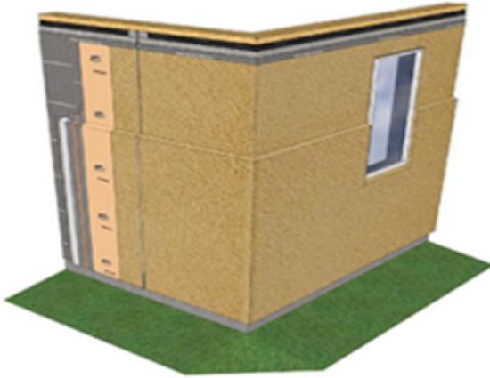
El aislamiento externo es adherido a la superficie de la pared con un adhesivo para aislamiento externo. Malla de refuerzo es incrustada en la capa de base del aislamiento externo y aplicado a la superficie de la pared.
