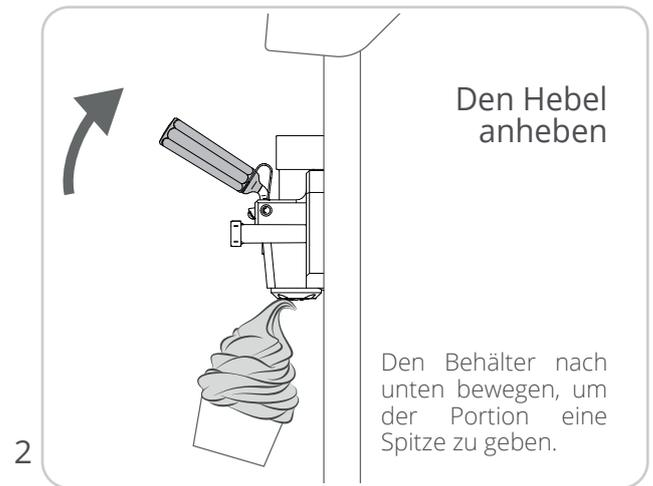
Das Eis verteilen, ohne den Produktionsrhythmus der Maschine zu überschreiten, wie in der Tabelle im Abschnitt „Technische Daten“ angegeben. Wenn dieser Rhythmus nicht überschritten und die Maschine mit frischem Produkt nachgefüllt wird, kann man sicher sein, dass der Verkauf nie unterbrochen werden muss, auch nicht während der Stoßzeiten.
