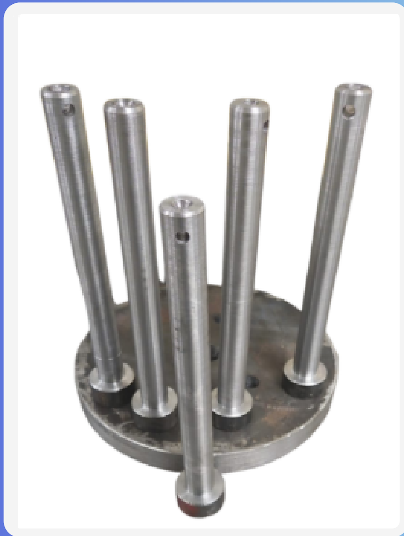
PERNOS DE 7/8" CON BARRENO LATERAL
