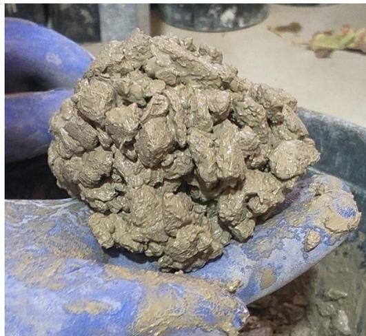
Figura 23. Ejemplo de hormigón permeable con apariencia visual adecuada.
