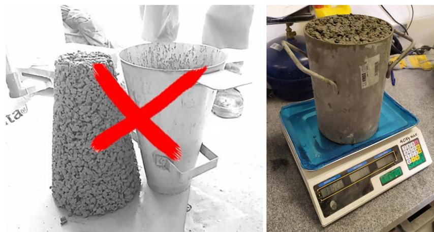
Figura 24. Ensayo del cono de Abrams en hormigón permeable (no recomendable como control de recepción), y ensayo de densidad en estado fresco (ensayo recomendado).
