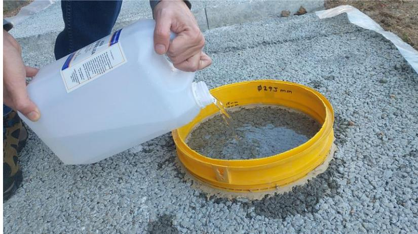
Figura 32. Ensayo de tasa de infiltración según ASTM C1701.
