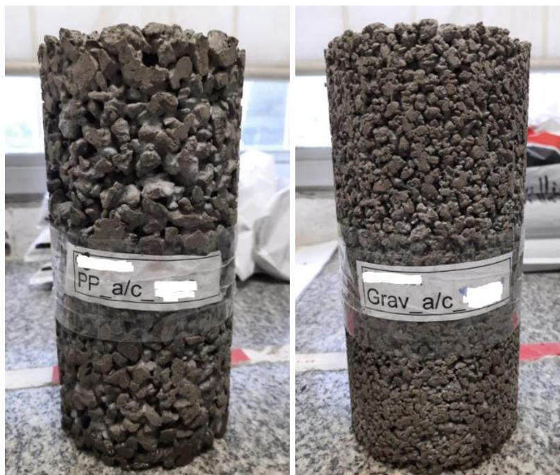
Figura 15. Probetas ( $\phi 10$  cm x 20 cm) de hormigón permeable con piedra partida (TMA: 14 mm) y gravillín (TMA: 10 mm) como agregado grueso.
