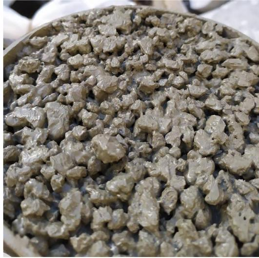
*Figura 1. Aspecto del hormigón permeable en probeta cilíndrica.*
