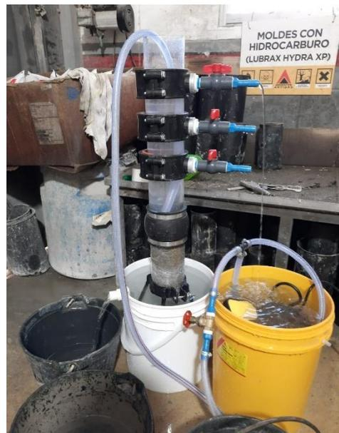
Figura 11. Esquema e imagen del permeámetro de carga constante.
