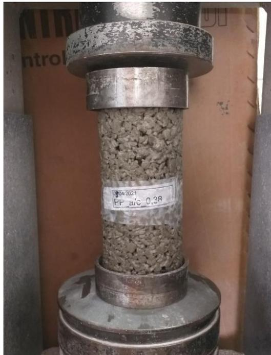
Figura 12. Probeta cilíndrica en ensayo de resistencia a la compresión.
