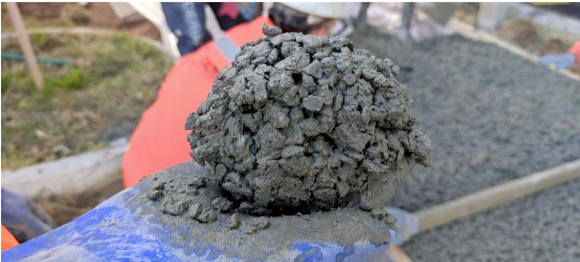
*Figura 8. Apariencia del hormigón permeable en estado fresco.*
