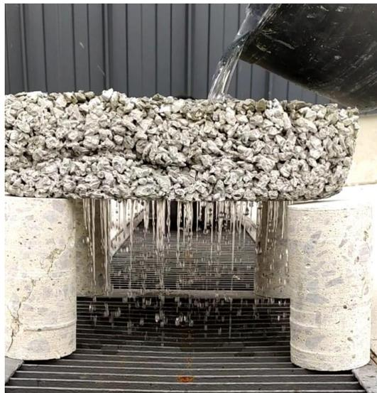
*Figura 2. Loseta demostrativa de hormigón permeable filtrando agua.*
