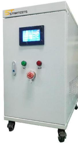
FT系列程式控制交流變頻電源，以微處理器為核心，採用PWM方式制作，正弦脈寬調制等技術，單機容量覆蓋1kVA-800kVA，輸出電壓10-300V、頻率45-65Hz無級數位可調，輸出可以類比世界各地不同電壓及頻率，具有負載適應性強、輸出波形品質好、操作簡便、體積小、重量輕等特點，具有完善的短路、過流、過壓、過熱等保護功能。
