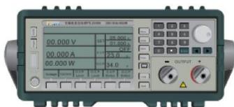
FTL 系列是一款高性能、多功能、中小功率的可程式設計直流線性電源。產品穩定成熟，並具有超載、極性接反、過壓、過流、過溫度等全面的保護功能，可保持電源和負載在不穩定環境下的工作安全。FTL 具有 $<0.01\%$ 的調整率， $<1\text{mVRms}$ 的紋波和雜訊及良好的瞬態性能，適用於像電流突波的應用環境。FTL 系列既適用於高指標的實驗室使用，也適用於高性能的測試系統使用。
