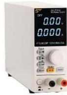
FTL系列是寬範圍可攜式可程式設計直流電源，具有同類產品最寬廣的電壓電流使用率，大大提高了應用範圍。以FTL8005P為例，100W的功率，輸出值在80V/5A內可調，自動控制電壓和電流的變化率，功率比達到四倍之多。一台機器可替代以往80V×1.2A/60V×1.6A/32V×3.1A/20V×5A四種機型，減少您的重複投資。提供多種通訊介面，具有豐富的SCPI和MODBUS指令，方便組建各種測試平臺。廣泛適用於電池充電器、高壓超高速二極體、電解電容、機電控制領域以及ATE測試系統等。
