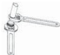
Die Montagerichtung des Ventils beachten. Für die Ventile von **CIAT** gilt die Fließrichtung **A > AB** (A = Anschluss an Register und AB = Anschluss an Wasserleitung). Der maximal zulässige Differenzdruck für die Ventile (offen oder geschlossen) beträgt 100 kPa. **CIAT** empfiehlt, 60 kPa nicht zu überschreiten.
