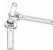
Bien respecter le sens de montage de la vanne. Sur ces vannes **CIAT** la circulation doit se faire de **A > AB** (A étant raccordé côté batterie et AB côté réseau hydraulique). La pression différentielle maximale admissible sur nos vannes (ouvertes ou fermées) est de 100 kPa. **CIAT** préconise de ne pas dépasser 60 kPa.
