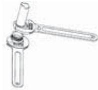
Houd u aan de montagerichting van het ventiel. Op deze **CIAT** ventielen moet de circulatie gaan van **A > AB** (A is aangesloten aan de kant van de batterij en AB aan de kant van het hydraulisch circuit). Het maximaal toegestane drukverschil op onze ventielen (open of dicht) is 100 kPa. **CIAT** raadt aan om 60 kPa niet te overschrijden.
