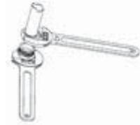
Pontosan tartsa be a szelep szerelési irányát. Ezeken a **CIAT** szelepeken az áramlási irány **A > AB** irányú legyen ("A" a fűtőegység felőli, "AB" a hidraulikus hálózat felőli csatlakoztatás). A szelepeinken (nyitott vagy zárt helyzetben) a maximális megengedett nyomáskülönbség 100 kPa. A **CIAT** azt ajánlja, ne lépje túl a 60 kPa értéket.
