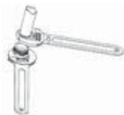
Строго соблюдайте направление при установке вентиля. Направление потока жидкости через клапан компании **CIAT**: **A > AB** (A присоединяется к теплообменнику, AB - к трубопроводу водяного контура). Максимально допустимый перепад давлений для данного клапана (в открытом и закрытом состояниях) составляет 100 кПа. **CIAT** рекомендует, чтобы перепад не превышал 60 кПа.
