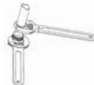
Przestrzegać prawidłowego kierunku montażu zaworu. W tych zaworach **CIAT** cyrkulacja powinna odbywać się z **A > AB** (A jest podłączony po stronie baterii, a AB po stronie sieci hydraulicznej). Maksymalne dopuszczalne ciśnienie zwrotne w naszych zaworach (otwartych lub zamkniętych) wynosi 100 kPa. CIAT zaleca, aby nie przekraczać wartości 60 kPa.
