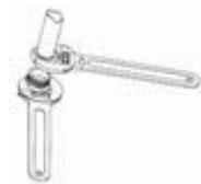
Rispettare il senso di montaggio della valvola. Su queste valvole CIAT la circolazione avviene in direzione  $A > AB$  (con A collegato sul lato batteria e AB sul lato rete idraulica). La pressione differenziale massima ammessa sulle nostre valvole (aperte o chiuse) è di 100 kPa. CIAT raccomanda di non superare i 60 kPa.
