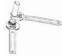
Respete el sentido de montaje correcto de la válvula. En las válvulas del **GRUPO CIAT** la circulación debe ir de **A > AB** (estando A conectado del lado de la batería y AB del lado de la red hidráulica). La presión diferencial máxima admisible en nuestras válvulas (abiertas o cerradas) es de 100 kPa. El **GRUPO CIAT** recomienda no sobrepasar los 60 kPa.
