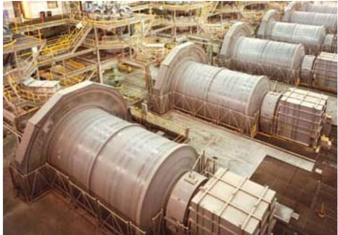
**Les larges engrenages à plateau lourdement chargés, comme ceux qu'on utilise dans ces broyeurs à boulet, présentent des défis particuliers quant à la lubrification ... Le lubrifiant EP à vaporiser pour engrenages découverts SWEPCO 222 relève ces défis.**
