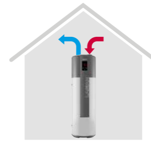
Entrée et sortie d'air directes de la pièce où il est installé
