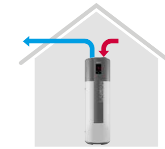
Entrée directe depuis la pièce où il est installé et sortie canalisée vers l'extérieur
