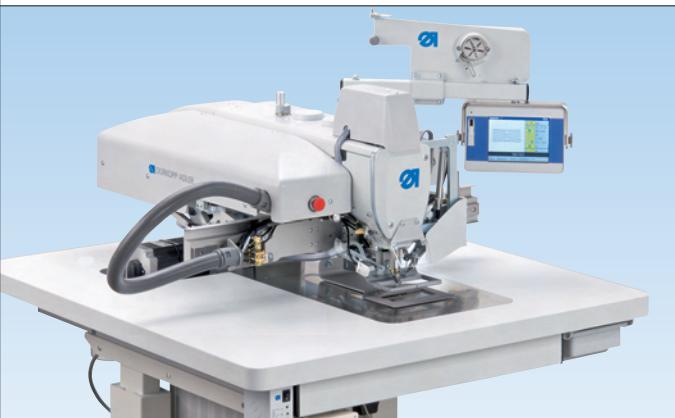
Durch die kompakte Bauweise, kombiniert mit der verstärkten Ausführung des Nähoberteils (M-TYPE), ist insbesondere der Bereich „Technische Textilien“ das Haupt Einsatzgebiet der Näh anlage.
