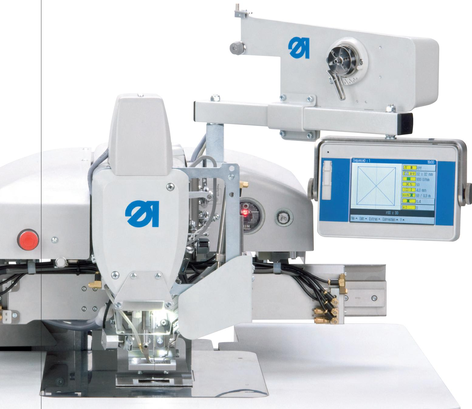
Das breite Anwendungsspektrum im Bereich von reproduzierbaren Sicherheits- und Funktionsnähten bei Technischen Textilien, Sicherheits- und Lastengurten, sowie dekorativen Ziernähten an Lederwaren stellen besondere Anforderungen an das Betriebsmittel.
