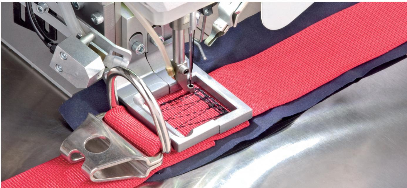
Bei der Fertigung von Sicherheits-, Zurr- und Lastengurten werden aufgrund der Verarbeitung extremer Nähgut- und Garnstärken höchste Anforderungen an die Betriebsmittel sowie an die Sicherheit und Belastbarkeit der Nähte gestellt.
