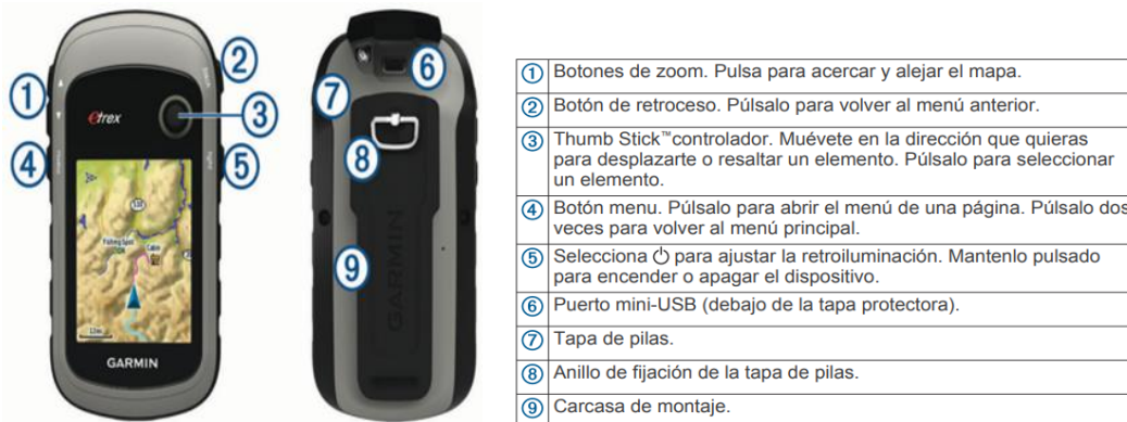
Ilustración 1 Descripción general del GPS GARMIN eTrex 10
