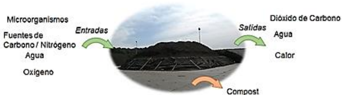
Figura 3. Esquema (compostaje) de la degradación aerobia de la FORSU.
