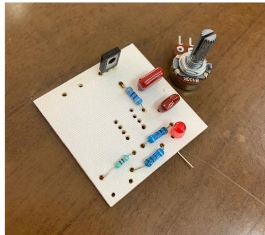
**Figura 1.** Placa fenólica con componentes instalados (en proceso).
