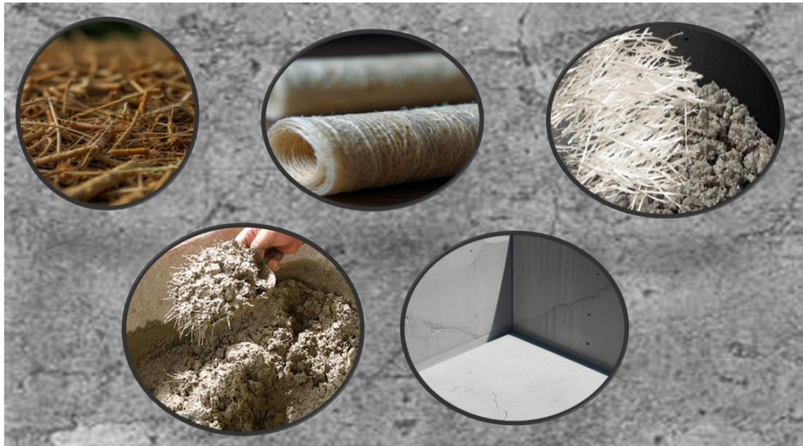
**Figura 2.** Fibra natural como reforzamiento en el concreto. Fuente: elaboración propia.
