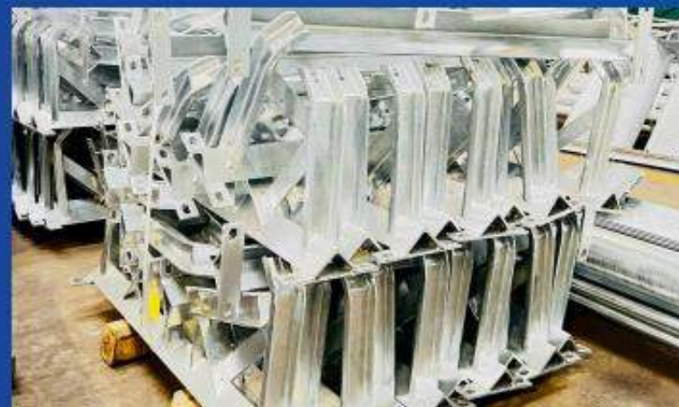
Kết cấu băng tải コンベア構造
