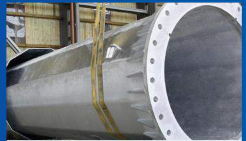
Kết cấu cột biển báo サインージュコラム構造
