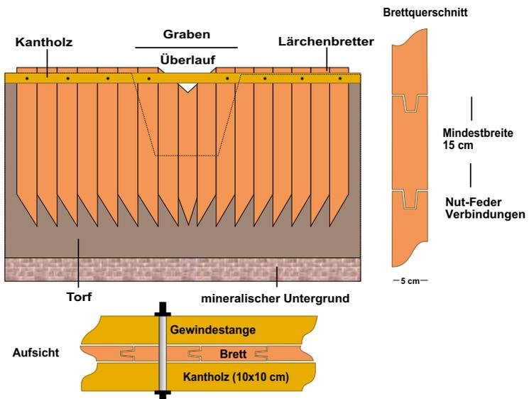
Abb. 20: Praktische Durchführung (Brettzuschnitt) Die Dämme wurden mit Nut-Feder-Brettern aus Lärchenholz gebaut, die, wie in der Graphik gezeigt, zugeschnitten waren. (Präsentation Steiner, 14022025)
