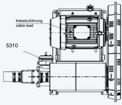
Freiraum für Wartungsarbeiten Stirnseitig min. 800mm
