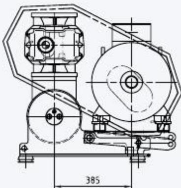
Motoraufbau beim GM 10 S mit Motor 200 L
