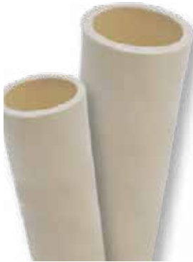
CPVC Agua caliente 82°C 125 psi máx. Tramos 3 m
