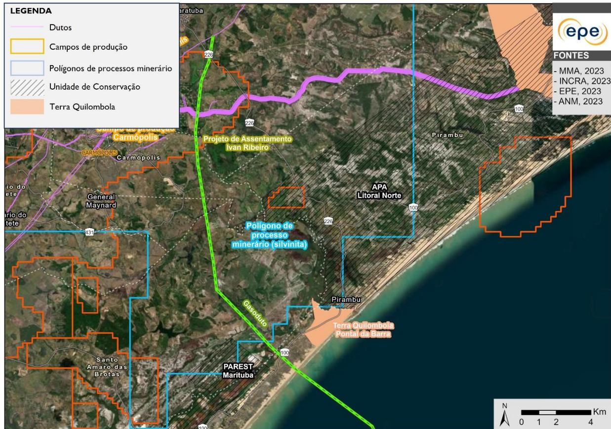
Figura 16. Área de chegada do gasoduto Sergipe Águas Profundas – malha TAG em terra Fonte: Elaboração Própria.
