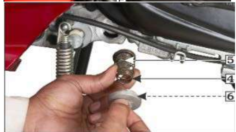
(4) Yay (5) Yağ süzgeci (6) O-ring
