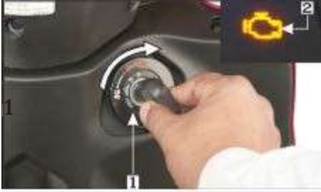
(1) kontak anahtarı (2) FI arıza lambası (MIL)
