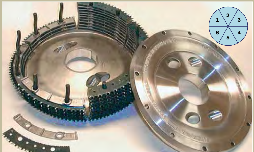
SATURN III AP Convex TURBO Stiftlänge 96 mm Radius 75 mm 36 3/8" AC Distanzstücke 6 3/16" AC Distanzstücke 36 Apollo III Rauklingen 12 Apollo Detreading Rauklingen
