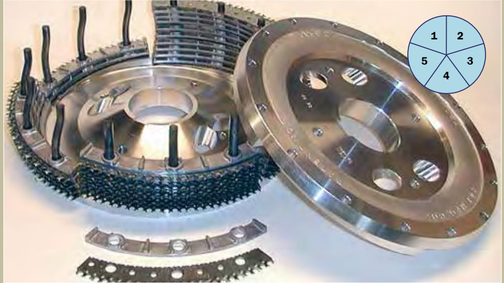
R 115 REG Convex TURBO, Stiftlänge 96 mm Radius 75 mm 45 1/4" AC Distanzstücke 50 R-115-25 S.C. Rauklängen
