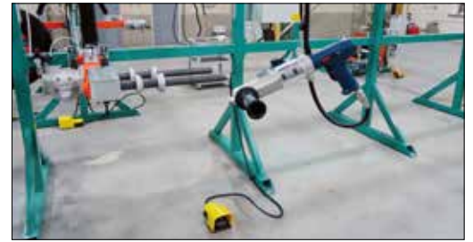
Estrusore per riempimento crateri Potenza 400 W / Peso 5 Kg
