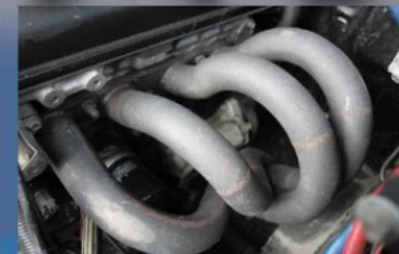
タコ足は独特の曲がり形状をしたテックアートの4-1を装着する。45φパイプ-60φ集合のステン製で高回転向けに作られた人気の定番パーツだ
