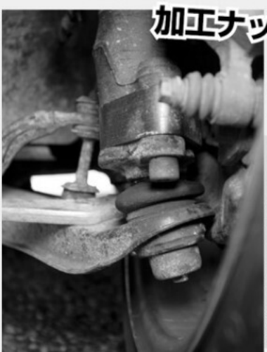
クスコアームでテンションロッド回りを補強する。ブレーキ時の挙動変化はドリフト、グリップ共に重要なところ
