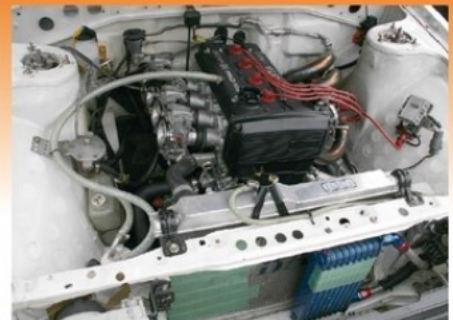
KMS (コシモズモータースポーツ) オリジナル83φピストン、KMSコンロッド、KMSオリジナルIN312度/EX304度カム、ポート研磨、TRDリテーナー等
