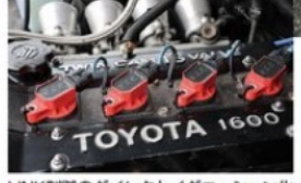
LINK制御のダイレクトイグニッション化がもたらす効果は絶大で、バイクのようなレスポンスを楽しむことができる。不要な配線を整理できるのも大きなメリットだ
