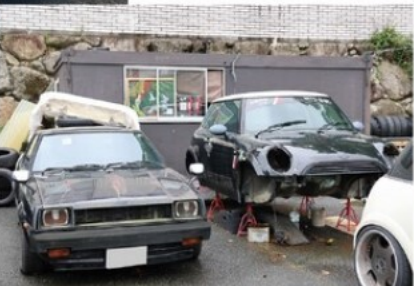
セオリー無視の魔改造系チューニングもゴーストタウンの得意とする分野。右奥のミニはRX-8用13B-MSPロータリーを搭載すべく、フロア周りの大改修の真っ最中だった
