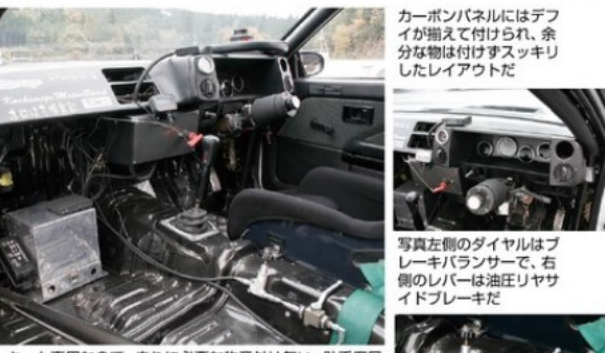
サーキット専用なので、走りに必要な物以外は無い。助手席下のアルミの箱はバッテリーBOX、バケツはブリッドを装着する。各部にスポット増しを施し剛性を上げている
