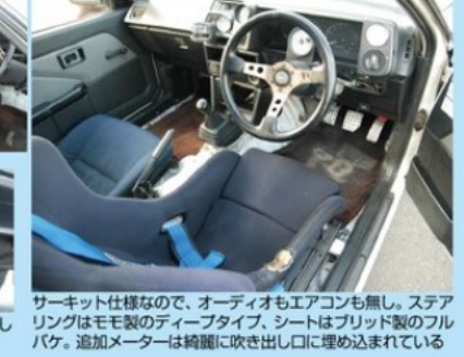
サーキット仕様なので、オーディオもエアコンも無し。ステアリングはモモ製のディーブタイプ。シートはブリッド製のフルバケ。追加メーターは純正に吹き出し口に埋め込まれている
