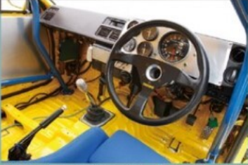
徹底した軽量化のため内装は一旦すべて撤去され、ドア内張りやインパネはアルミで製作。オートメータコ・水温・油温・油圧・空燃比計を装着する
