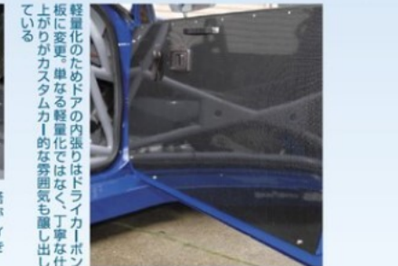
軽量化のためトアの内張りにはドライバーポン板に変更。単なる軽量化ではなく、丁寧な仕上げがカスタムカー的な雰囲気も醸し出している
