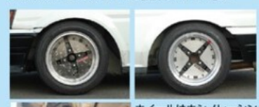
ホイールはホシノレーシングの14インチで、前7.5J、後ろ8J。オフセットは共に0。足回りは、オーナーがとて走りやすいというビルズ製を前後に装着する
