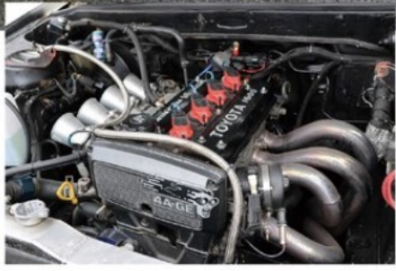
河口社長の愛機86。マウント加工により搭載位置が低められたエンジンはAE92後期用4A-G。カムシャフトを戸田レーシング(IN272/EX288)に変更した以外、排気量はノーマル。4連スロットルはAE101用で、インジェクターはサードの300ccを使用。バッテリー電圧に十分余裕がある時はオルタネーターの駆動をカットする機能も盛り込む
