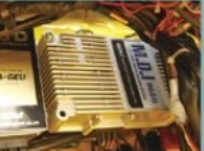
点火系はMDIで強化。専用コイルをダッシュボード裏に設置しているため、プラグコードがダッシュ裏に伸びる
