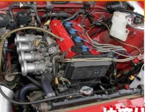
駆下ノーマル、INノーマルX度カム、ヘッド面研、AE92用強化クラッチ、AE92用クラッチなどでチューニングされている
