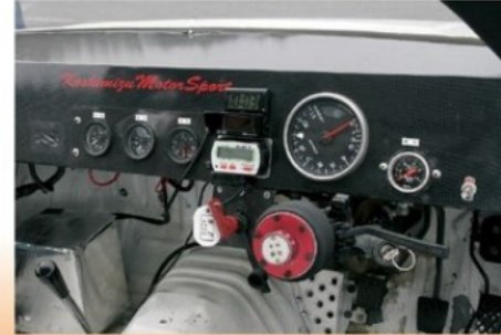
タコ、油温、油圧、水温、燃圧の各メーターが付き、ラップタイムを表示するP-LAPⅢが付く。ダッシュボードはカーボンパネルで作られているので非常に軽量だ
