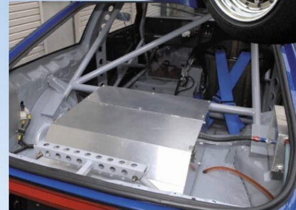
初代REハチロクは、適当なボディに現成のエンジンを搭載した状態で岡山国際サーキット48秒。パランス的に行けるが、フル補強したボディを新規に製作したのがこのハチロク。ロールオーバーはピラミッドと完全に固定され、ワントップのタックシヨボードにはDefierのスーパースポーツクラスターを装備する。ロールオーバーとボディの接合部は、単にボディパネルに溶接するのではなく、台座を作って接合部自体の剛性も上げる。レース界では常識の作業も、国松自動車では当たり前。
