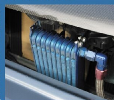
オイルクーラーは定番のトラスト。冷却系はこれで問題なし。冬場になると水温はやや冷えすぎるのでラジエターには目張りをして対策する
