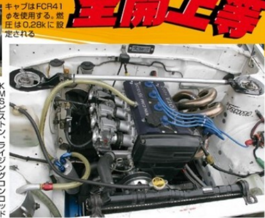
キャブはFCR41φを使用する。燃圧は0.28kに設定される
