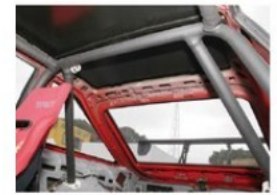
フロアは密着増しされた品式ロールバーで補強されている。追加メーターがタコ油圧・水温・電圧計で、ステアリングはOMP、シートはブリッド、SPRINGはインソスタートコロンを適用している
