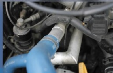
5バルブ4A-G載せ替えに付きもの、冷却水取り回しの逆転配管の様子。耐久性とパワーを存分に使うことを考えると、5バルブ換装が現在は主流になっているかもしれない
