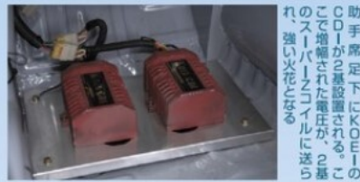
助手席足下にKOEIのCDIが2基設置される。ここで増幅された電圧が、2基のスーパーキャパシタールに送られ、強い火花となる。
