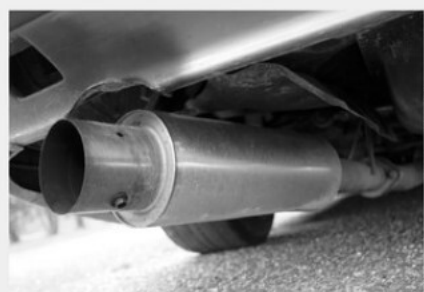
マフラーはGPRスポーツのラフド60φ。ちなみにISOはTRR、ファイナルギヤは47/78が組まれている
