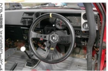
フロアは密着増しされた品式ロールバーで補強されている。追加メーターがタコ油圧・水温・電圧計で、ステアリングはOMP、シートはブリッド、SPRINGはインソスタートコロンを適用している
