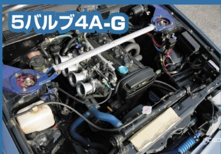
5バルブ4A-G載せ替えに付きもの、冷却水取り回しの逆転配管の様子。耐久性とパワーを存分に使うことを考えると、5バルブ換装が現在は主流になっているかもしれない
