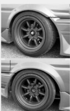
定回りは前後トラストのパフォーマンスダンパーを組む。前のスプリングはスイフトの8キロに変更。ホイールはRSワタナベ8.5Jの15インチ(オフセット-6)。タイヤは195-50サドリフトD1を使う
