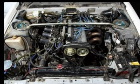
5Vレブの4A-Gを搭載し、TRD製の0.8mmヘッドガスケット、カムはIN、EX共に304°でリフト量は9mm。CPUはフリーダムでエンジンを制御する
