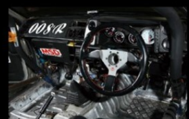
太めのグリップに赤ステッチのパーソナルのステアリング、Defin製のリンクメーター、自作ロールオーバー、ブリッドのフルバケを装備し、それ以外の無駄な物ははぎ取られ軽量化された内装。走るために必要な最低限の装備のみを残す
