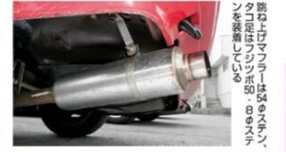
跳ね上げマフラーは54φステン、タコ足はフジツボ50.8φステンを装着している
