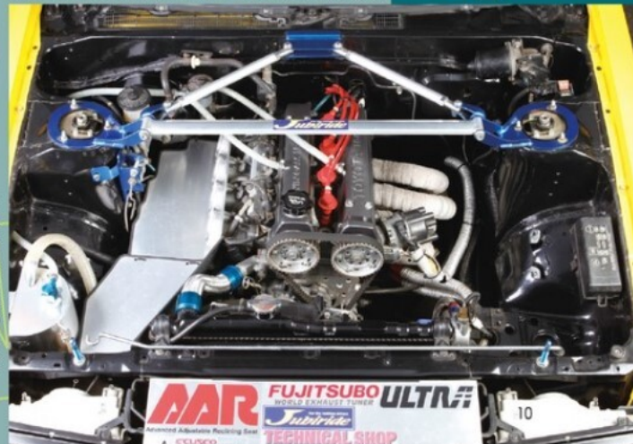
オリジナルのインマニアダプター、デリバリーパイプ、スリーブファンネルで武装したAE101スロットル
