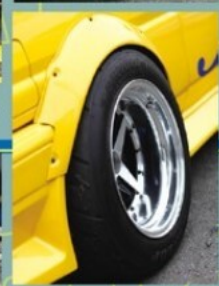
ディープなエキップ01のオフセットはフロント-16、リヤ-28。タイヤはF:205/50-15 R:225/50-15のD01J
