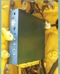
点火系はMDIで強化。専用コイルをダッシュボード裏に設置しているため、プラグコードがダッシュ裏に伸びる
