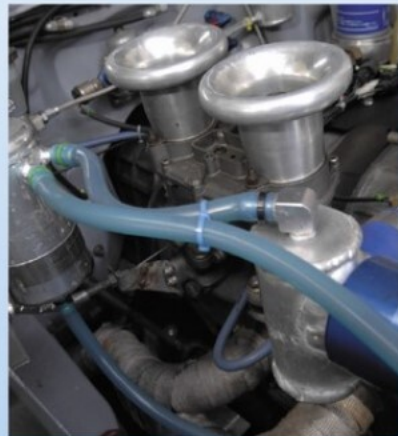
キャブはウェーバーダウンドラフト48φにカーボンファンネルを装備。エキマニはワントップの完全等長にモーターを巻いて、ロータリーの高温排気道に対応している。
