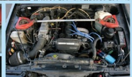
以前はカムも変えソレックス44φで乗っていたが、現在はインジェクション仕様の4A-G。吸排気系は、K&Nのエアクリ、リポバール製のタコ足、HKSのハイパーマフラーを装備
