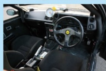
女性オーナーならではの綺麗な室内だが、ドア周辺のスポンジ増しや、7点式のロールオーバーゲージなど補強系も万全
