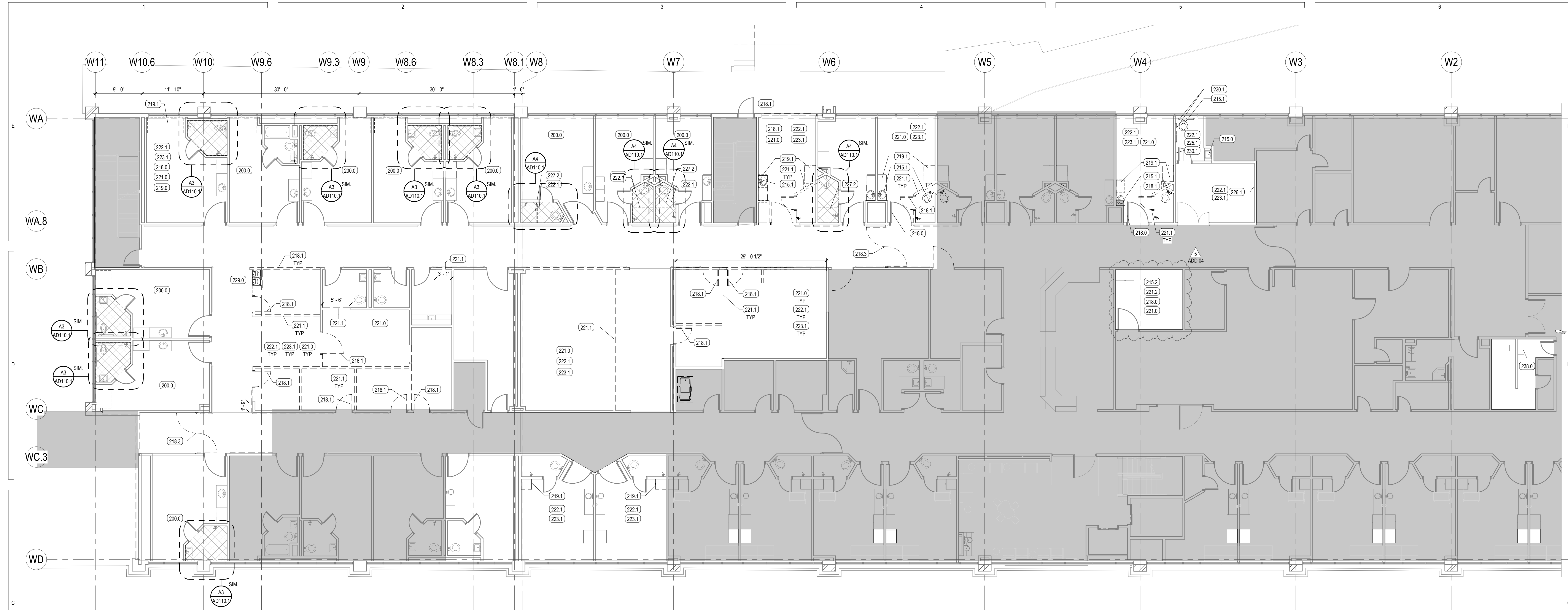
C3 LEVEL 1 - DEMOLITION PLAN SCALE: 1/8" = 1'-0"
