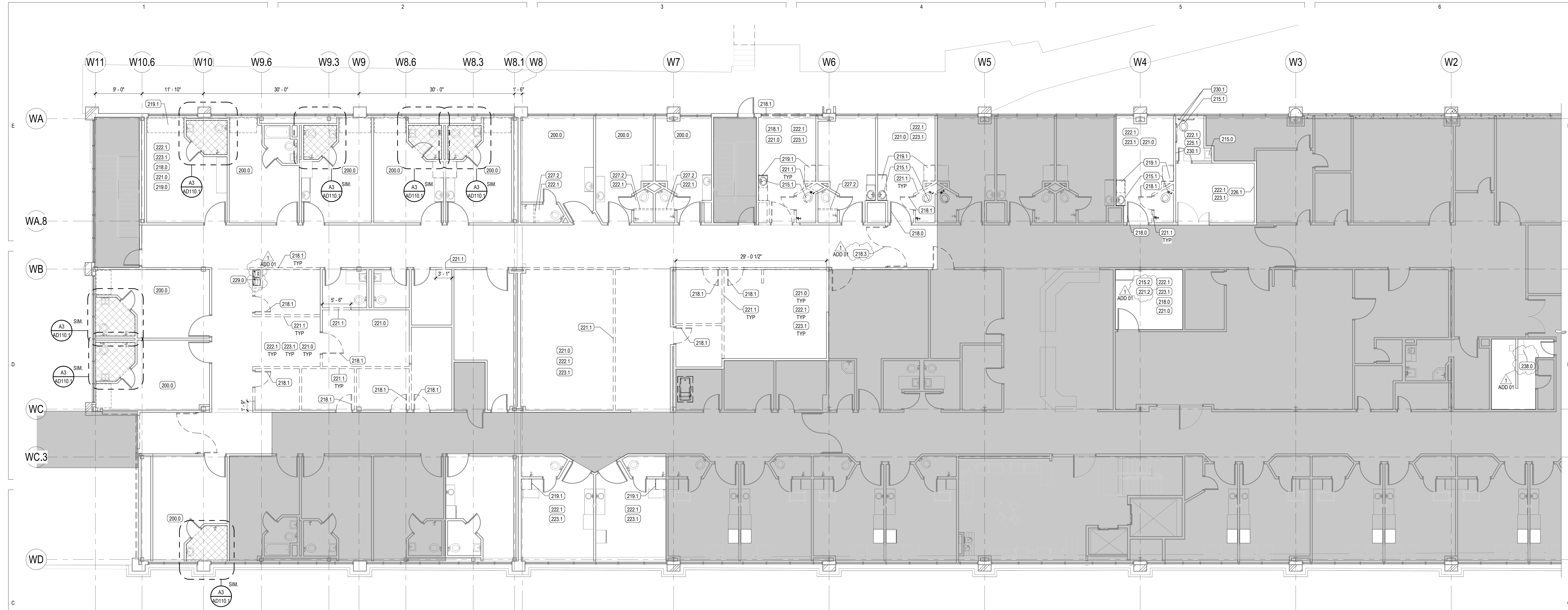
C3 LEVEL 1 - DEMOLITION PLAN SCALE: 1/8" = 1'-0"
